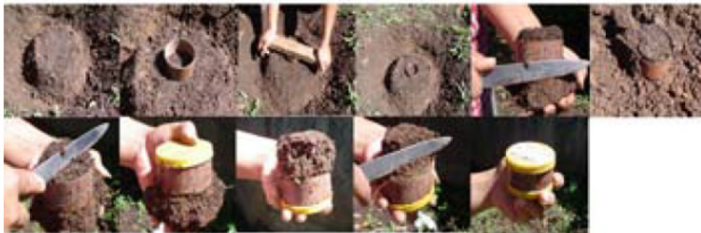
FIGURA 14 ETAPAS DEL MUESTREO DEL SUELO UTILIZANDO UN ANILLO DE MUESTREO (DE LA ESQUINA SUPERIOR IZQUIERDA A LA ESQUINA INFERIOR DERECHA)
